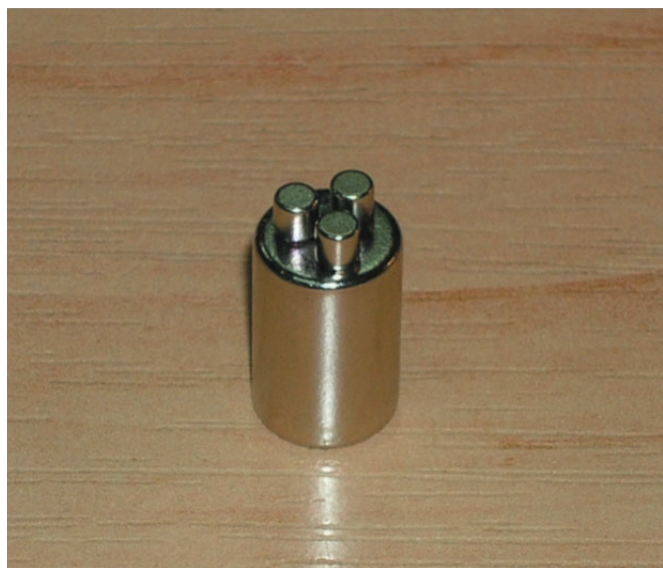
Рис. 6. Магніт № 2 з вантажем-противагою в 480 мг. з такою противагою магніт № 2 опускається по трубці з однаковою швидкістю, незалежно від того, яким полюсом вниз він опускається.
