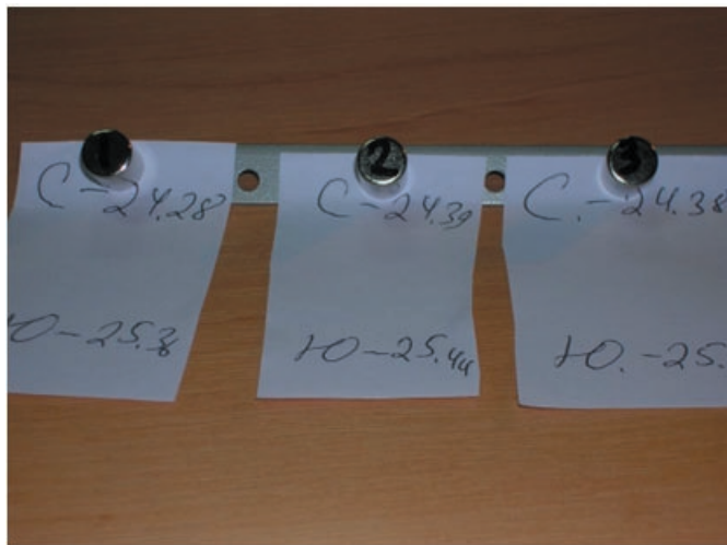
Рис. 5. Магніти для експерименту. Маркований південний полюс магніту.
